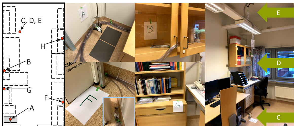
Figur 2. Skiss och foton över platser (A-G) i rummet där luftprovtagning utfördes. Position A var placerad 25 cm ovanför de två klinkerplattor där spill applicerades.
